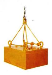
Separam as impurezas ou peças ferrosas do material não magnético transportado por correias, alimentadores vibratórios, etc Utilizados em pedreiras, minerações, siderúrgicas, cerâmicas, plantas alimentícias, etc, agem por "extração", ou seja, são instalados externamente ao transportador (evitando modificações ao sistema pré-existente) e "captam" o material ferroso que passa sobre ou sob o separador.
